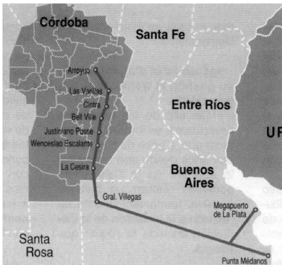
Figura N° 1: Proyecto de Hidrovía Artificial Mediterránea. Autores: Ingenieros Villa Uría, Actis y Braceras. Cátedra de Obras Hidráulicas. Facultad de Ciencias Exactas, Físicas y Naturales. Universidad Nacional de Córdoba (Período 1991-1998) 72 .
